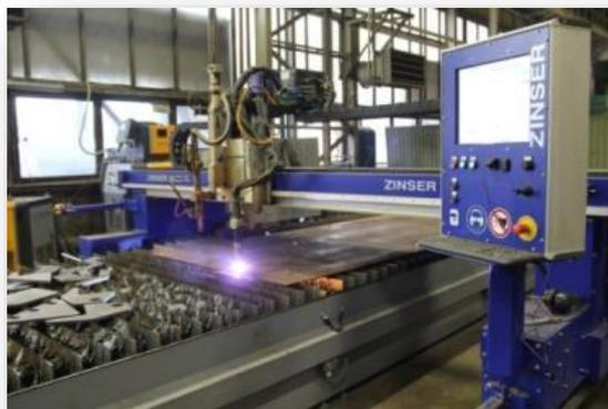
**Установка плазменной резки**
